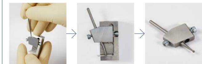
ビットのセッティング 薄い紙を敷いて高さ調整用治具にセットします。ビットをネジで固定し治具からヘッド全体を取り外します。
