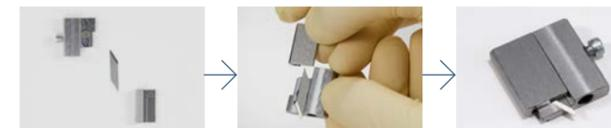
カッターのセッティング 本体にカッターを装着します。カッターが外れないようカバーをつけます。
